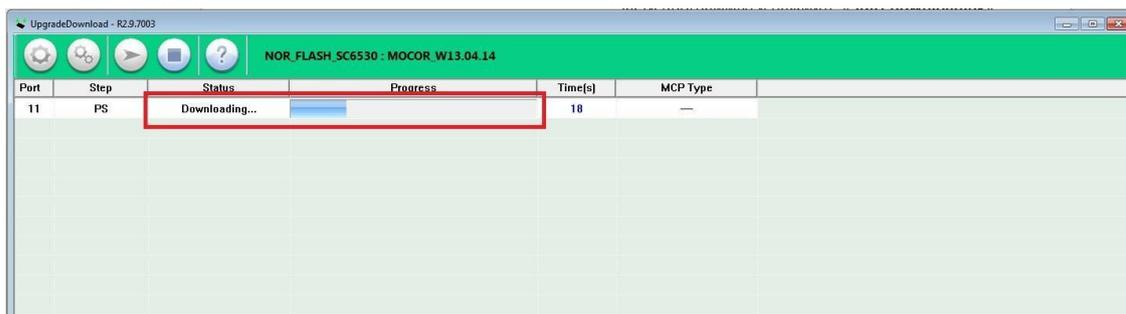
**Шаг 8.** Как ПО установится, в строке загрузки зеленым цветом отобразится «**Passed**». После чего устройство можно будет отсоединить от компьютера и закрыть окно программы «**UpgradeDownload**» предварительно остановив процесс кнопкой «**Stop downloading**».
